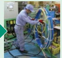
0.5~2.5MPaの脈動圧をかけ、漏れがないか確認します。
