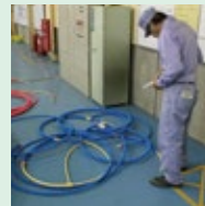
加工図を基に製作されているか検査を行う。
