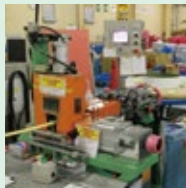
加工図を基にパイプを切断します。(自動切断機)
