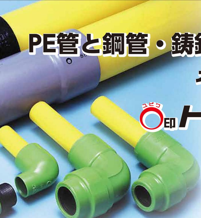
ガス導管は、従来鋼管・鋳鉄管が主流でしたが、近年耐食性、耐震性などの利点からポリエチレン管へと移行しつつあります。そこで当社は、今後ますます需要が増加するポリエチレン管配管の接続部への信頼性、および接続作業の向上をはかった継手の開発に着手し、このたび「トランジション継手」を商品化いたしました。この継手は、ポリエチレン管と鋼管・鋳鉄管とを連絡するため、あらかじめ継手本体にポリエチレン管を組み込み、一体化された継手で、本管・支管からの先継ぎや分岐取り出しが簡単に行えます。また、豊富な品種により、あらゆる施工条件に対応することができます。
