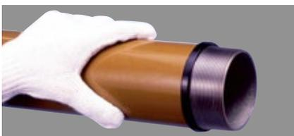
1. 管のねじ部及び被覆斜面に有害な傷のないことを確認し、接続部の切り粉や付着物（ゴミ、油、水など）をきれいに拭き取って下さい。
